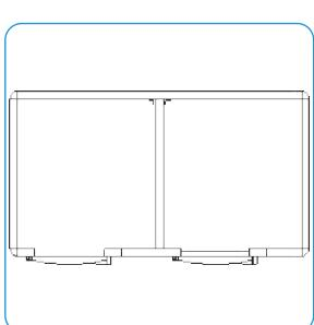
La chambre Optima peut être divisée en son intérieur par une cloison en panneau blanc/blanc. La cloison se fixe par le moyen de profils en tôles et de vis auto foreuses.
