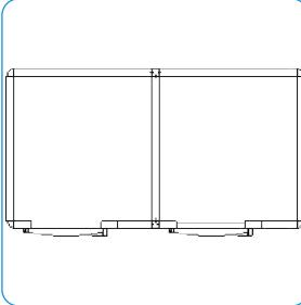
Deux chambres Matrix peuvent être accolées avec des profils-T. En ce cas on peut combiner des différentes zones de température sans des ruptures thermiques supplémentaires.
