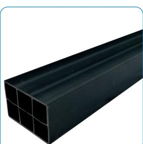
Il s'agit d'un profil rectangulaire en PVC de 60 x 40 mm conçu pour améliorer la mise à niveau du sol pour le montage des planchers ainsi que pour garantir le passage de l'eau pour les chambres soumises aux intempéries et éviter la condensation dans le sous-sol de l'enceinte frigorifique.
