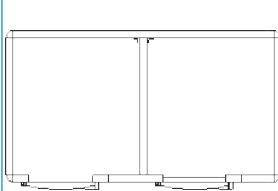
La chambre Matrix peut être divisée en son intérieur par une cloison en panneau blanc/blanc. La cloison se fixe par le moyen de profils en tôles et de vis auto foreuses.
