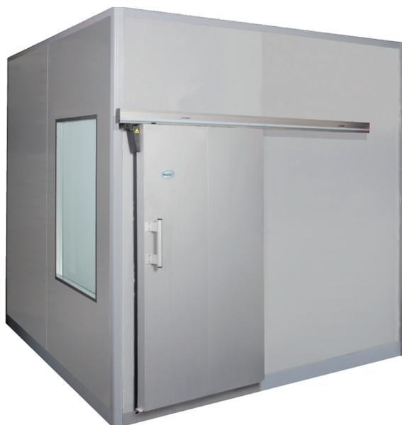
De deurbladen van schuifdeuren voor MATRIX 60, 85 en 105 zijn steeds vlak uitgevoerd. De buitenzijde wordt uitgevoerd in gegalvaniseerde voorgelakte staalplaat, met plaatdikte van 0,5 mm en kleur Grijs RAL 9006. De binnenzijde wordt uitgevoerd in gegalvaniseerde voorgelakte staalplaat, met plaatdikte 0,5 mm, kleur is WIT referentie 1006.
