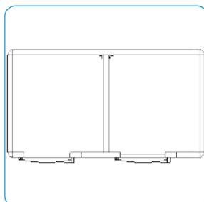
Een Matrix koelkamer kan inwendig ingedeeld worden, door middel van een tussenwand in wit/ wit uitvoering. De tussenwand wordt bevestigd met gelakte profielen en zelftappende schroeven.
