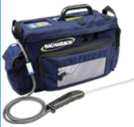
Le détecteur de gaz à infrarouge PGM vous offre une performance et fonctionnalité supérieure pour la détection de, entre autres, CO<sub>2</sub>.
